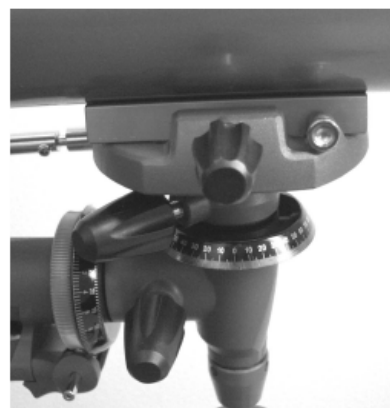
Figura 2-18 Tornillo de fijación y mando de seguridad de la plataforma soporte para el tubo
