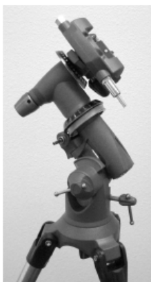
Figura 2-17 Mando de bloqueo de Dec encima del disco de Dec. Mando de bloqueo de A.R. encima del eje de A.R.
